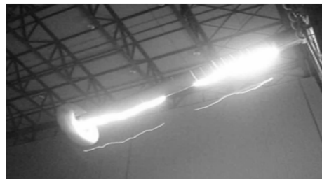
图 3 800 kV 直流套管闪络图
